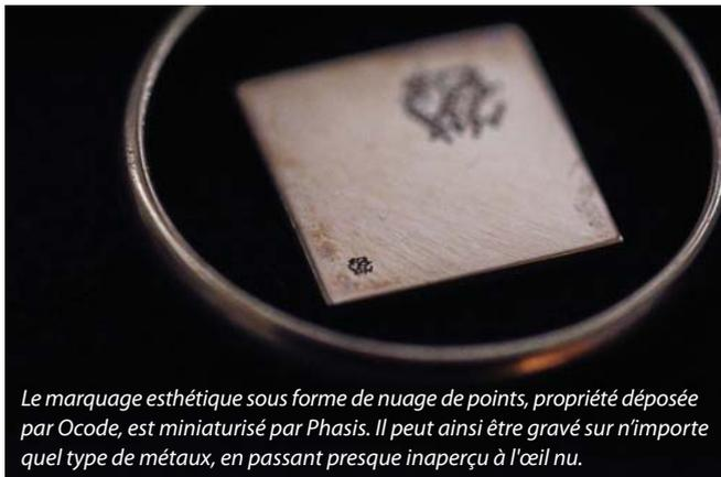
Le marquage esthétique sous forme de nuage de points, propriété déposée par Ocode, est miniaturisé par Phasis. Il peut ainsi être gravé sur n'importe quel type de métaux, en passant presque inaperçu à l'œil nu.
